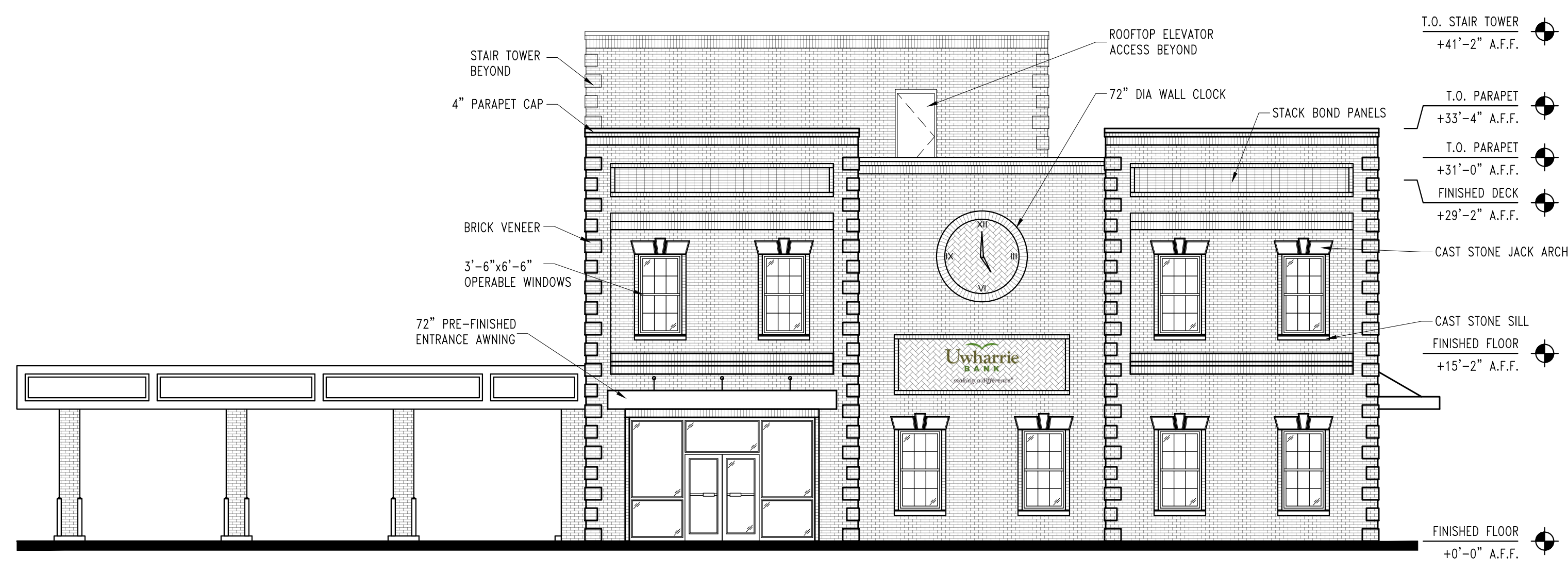
1 FRONT ELEVATION SCALE: 1/8" = 1'-0"
